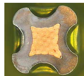
Querschnitt eines Vierdorncrimps Cross-section of a four-indent crimp
