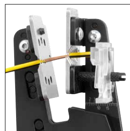
Abisolieren durch Formmesser Stripping with profile blades
