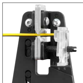
Kabel an Längenschnitz anlegen Position cable at length stop
